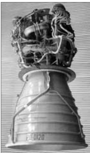
Главный двигатель РН «ЭНЕРГИЯ» РД-0120 . Тяга - 190 тс
